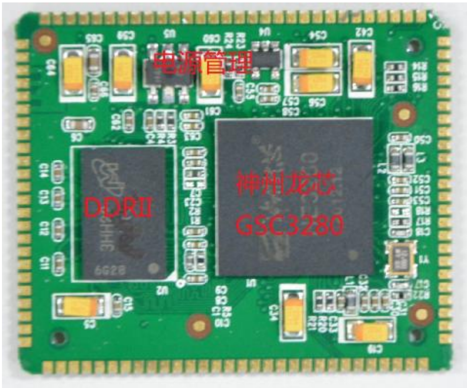
图 1-1 GSC3280 核心板实物图(正面)
