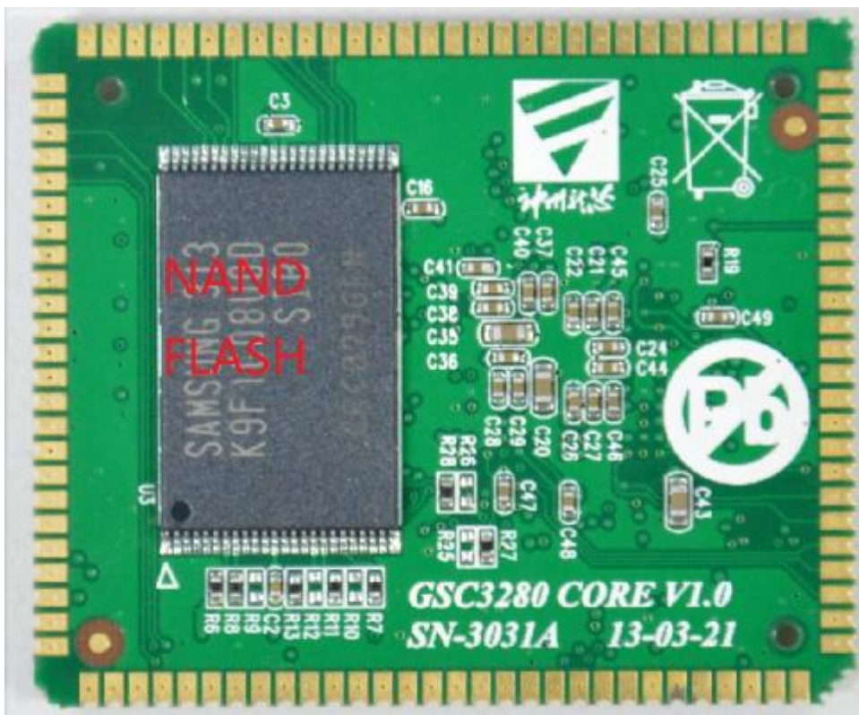
图 1-2 GSC3280 核心板实物图(背面)
